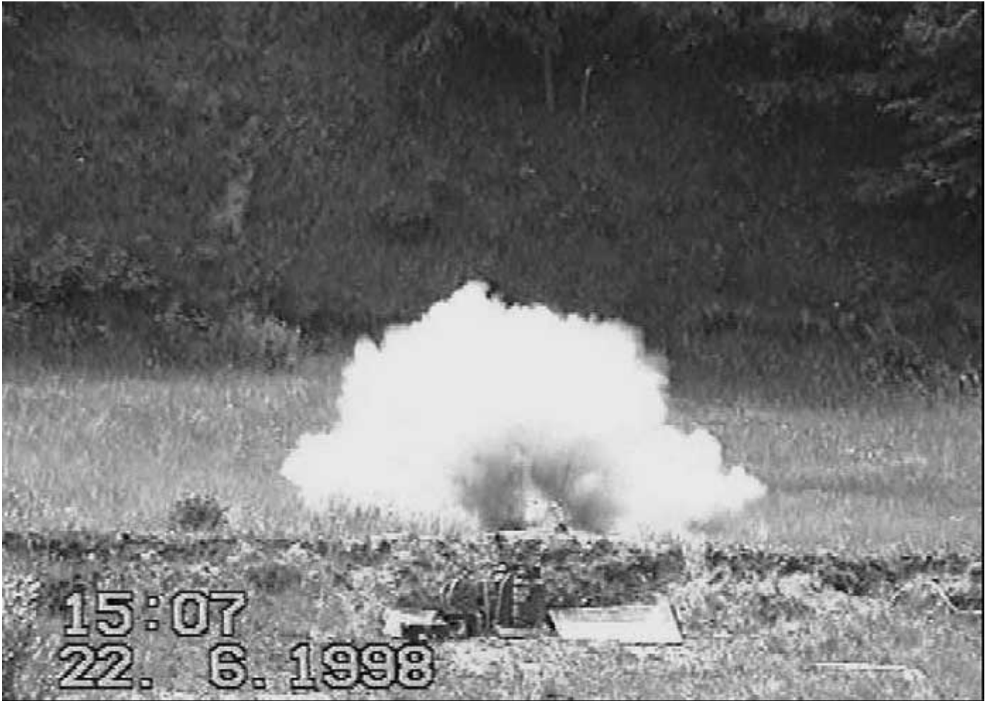
Hình 5: Đám mây propan sau khi nổ bình.
